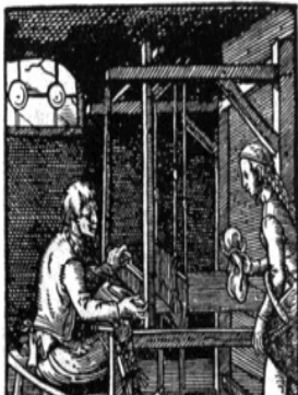
Рис. 4. Горизонтальний ткацький верстат. Німецька гравюра XV ст.
