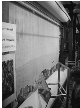
Рис. 5. Вертикальний верстат на мануфактурі Гобеленів
