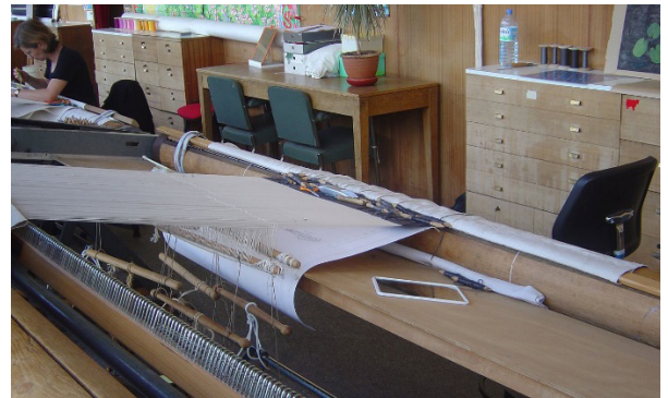
Рис. 6. Горизонтальний верстат на мануфактурі Гобеленів
